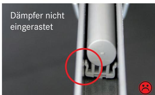
Dämpfer verschieben bis er einrastet!
