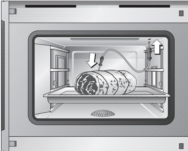
Der Kerntemperaturfühler ermöglicht exaktes, punktgenaues Garen.
